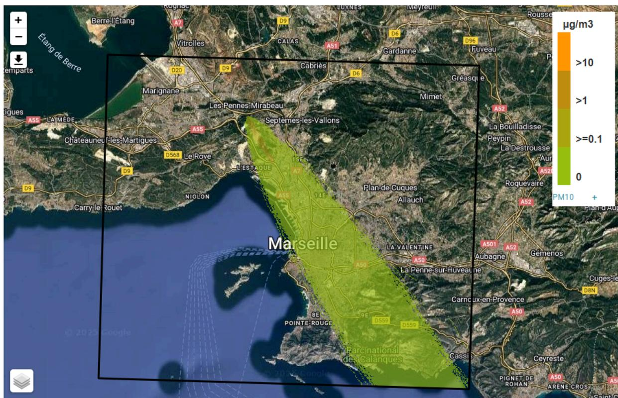
*Simulation du panache de fumée réalisée à 13h par AtmoSud.*
