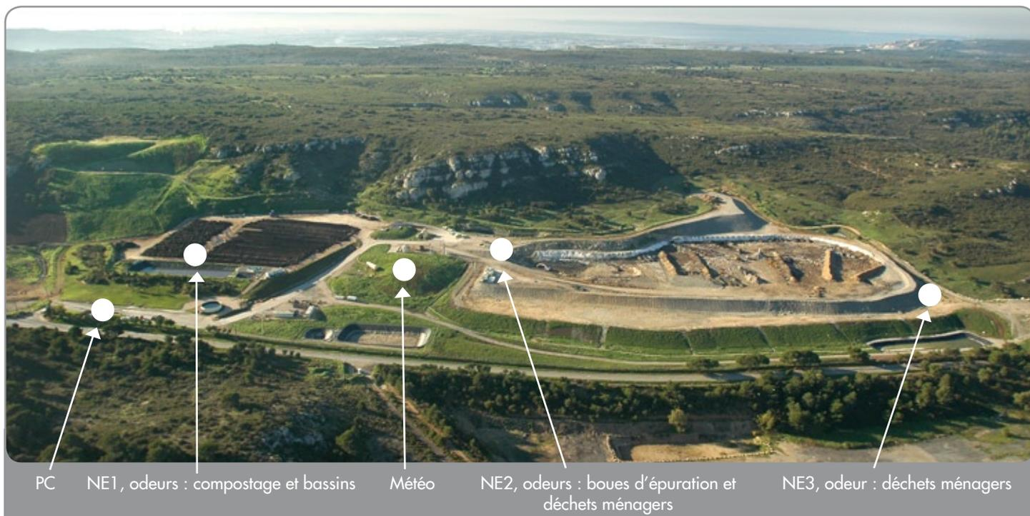
Déploiement du système Odowatch sur le centre d'enfouissement technique : position des 3 nez électroniques (NE1, NE2 et NE3), de la station météo et de la plate forme de modélisation (PC).
