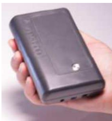
Figure 14 : Aéthalomètre microAeth MA200
