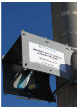
Appareils de mesures du benzène (tubes à diffusion passive).
