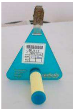
Appareils de mesures du benzène (tubes à diffusion passive).
