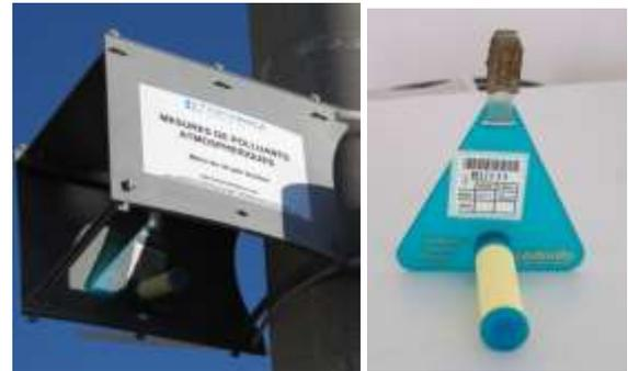
Dispositif de mesure du benzène (« tube benzène »).
