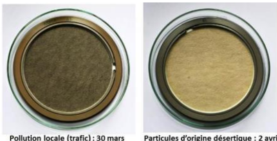
Filterre de prélèvement de particules fines d'Air PACA
