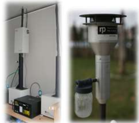
Préleveur de particules (installé en cabine de mesure) et tête de prélèvement extérieure.
