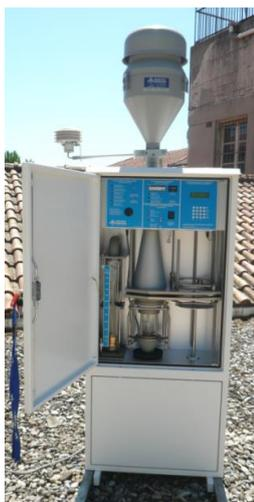
Figure 15 : équipement à haut débit pour les prélèvements dans l'air ambiant
