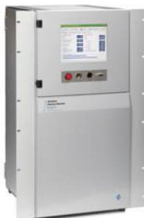
Figure 16 : granulomètre (DMPS) TSI 3031
