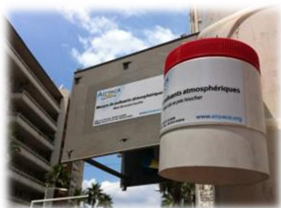
Figure 2 : Boîtes contenant les échantillonneurs passifs
