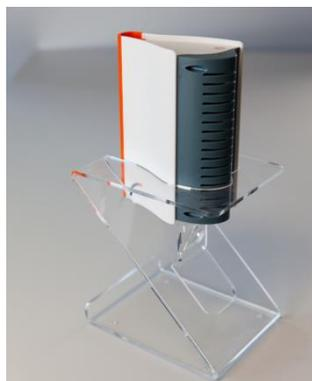
Figure 6 : Balise Fireflies (COVL, COVT, température, humidité relative, CO<sub>2</sub>, Bruit)
