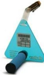
Figure 3 : Radiello 165 : Cartouche 165, corps diffusif bleu et support
