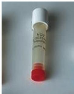
Figure 4 : Echantillonneur passif de NO<sub>2</sub> - Passam
