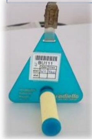
Dispositif de mesure du benzène (échantillonneur passif).
