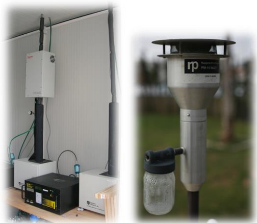
Préleveur de particules installé en cabine de mesure et tête de prélèvement extérieure.
