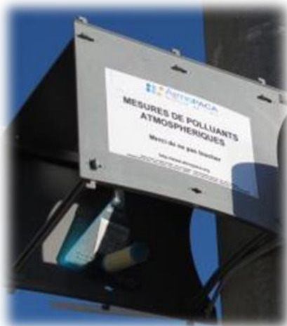
Dispositif de mesure du benzène (échantillonneur passif).
