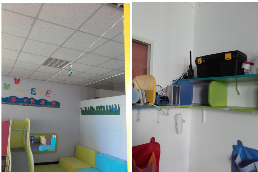
Figure 15 : Dispositifs de mesures chimiques à gauche et de particules fines, COV totaux et CO 2 à droite dans la salle n°1
