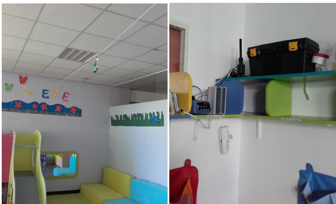
Figure 17 : Dispositifs de mesures chimiques à gauche et de particules fines, COV totaux et CO 2 à droite dans la salle n°2
