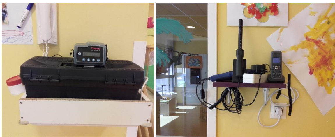
Figure 8 : Dispositifs de mesure de particules fines à gauche et de CO 2 à droite dans la salle n°1
