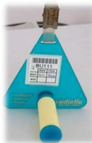
Photo 2 : Echantillonneur passif BTEX
