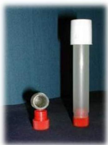
Photo 1 : Echantillonneur passif NO<sub>2</sub>
