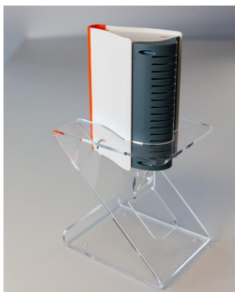
Figure 12 : Balise Fireflies (COVL, COVT, température, humidité relative, CO 2 , Bruit)
