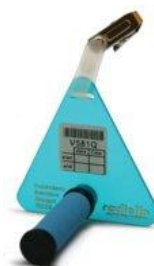
Figure 6 : Radiello 165 : Cartouche 165, corps diffusif bleu et support
