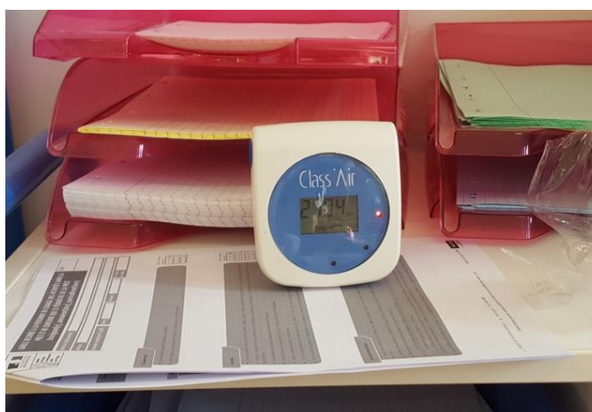
Photographie 85 : Exemple d'appareil de mesure de CO 2 pédagogique dans les salles de classe suite à la sensibilisation à la qualité de l'air intérieur par l'Air et Moi
