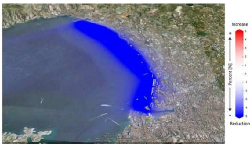
Figure 10 : Modélisation de l'impact d'un passage au GNL pour les navires de passagers à Marseille
