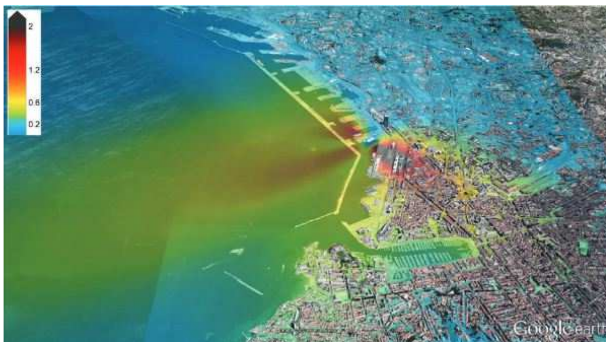
Figure 9 : Modélisation des émissions de NO2 de deux navires en stationnement à quai 12 heures par jour
