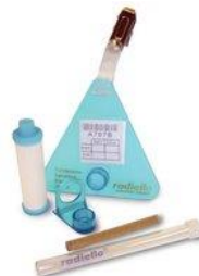
Figure 1 : Cartouche 145, corps diffusif jaune et support
