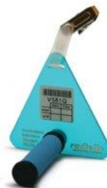
Figure 3 : Radiello 165 : Cartouche 165, corps diffusif bleu et support
