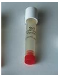
Figure 2 : Echantillonneur passif de NO 2 - Passam
