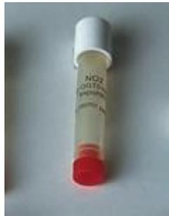
Figure 2 : Echantillonneur passif de NO<sub>2</sub> - Passam
