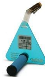
Figure 3 : Radiello 165 : Cartouche 165, corps diffusif bleu et support
