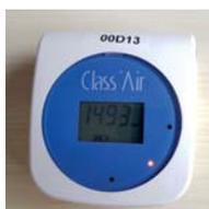
▲ Class'Air : appareil de mesure du dioxyde de carbone (CO<sub>2</sub>), température et humidité.
