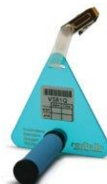
Figure 4 : Radiello 165 : Cartouche 165, corps diffusif bleu et support
