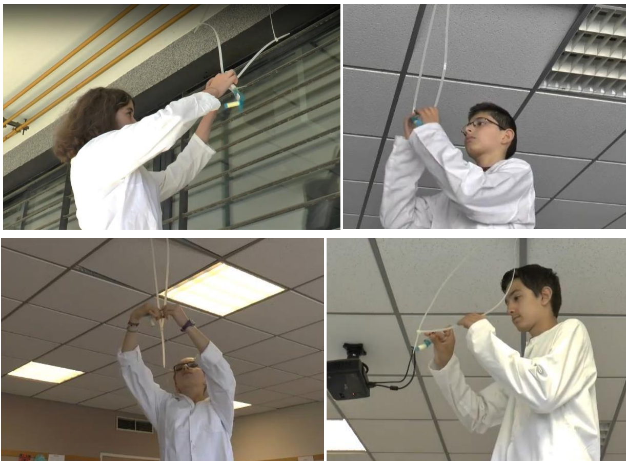
Figure 1 : Mise en place, par les élèves, des dispositifs de prélèvement du kit d'autodiagnostic au collège Pierre Puget du 1 er au 5 avril 2019
