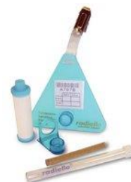
Figure 1 : Cartouche 145, corps diffusif jaune et support
