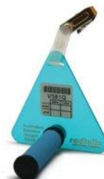
Figure 3 : Radiello 165 : Cartouche 165, corps diffusif bleu et support
