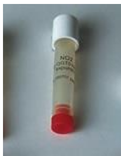
Figure 2 : Echantillonneur passif de NO 2 - Passam
