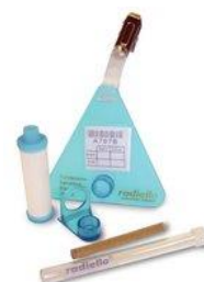
Figure 1 : Cartouche 145, corps diffusif jaune et support
