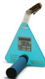
Figure 3 : Radiello 165 : Cartouche 165, corps diffusif bleu et support
