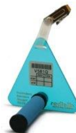
Figure 3 : Radiello 165 : Cartouche 165, corps diffusif bleu et support
