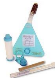
Figure 1 : Cartouche 145, corps diffusif jaune et support
