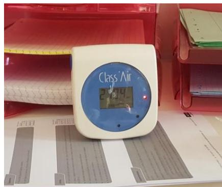
**Figure 5 : Appareil de mesure de CO<sub>2</sub>, température et humidité relative : Class'Air**
