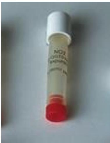
**Figure 3 : Echantillonneur passif de NO<sub>2</sub> - Passam**
