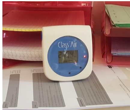
Figure 4 : Appareil de mesure de CO 2 , température et humidité relative : Class'Air
