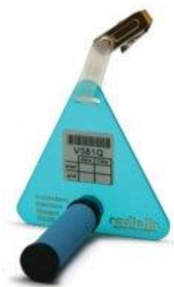
**Figure 4 : Radiello 165 : Cartouche 165, corps diffusif bleu et support**
