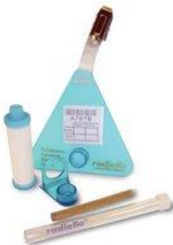
Figure 2 : Cartouche 145, corps diffusif jaune et support
