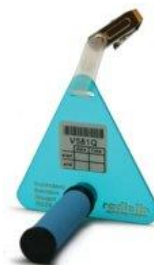
Figure 3 : Radiello 165 : Cartouche 165, corps diffusif bleu et support
