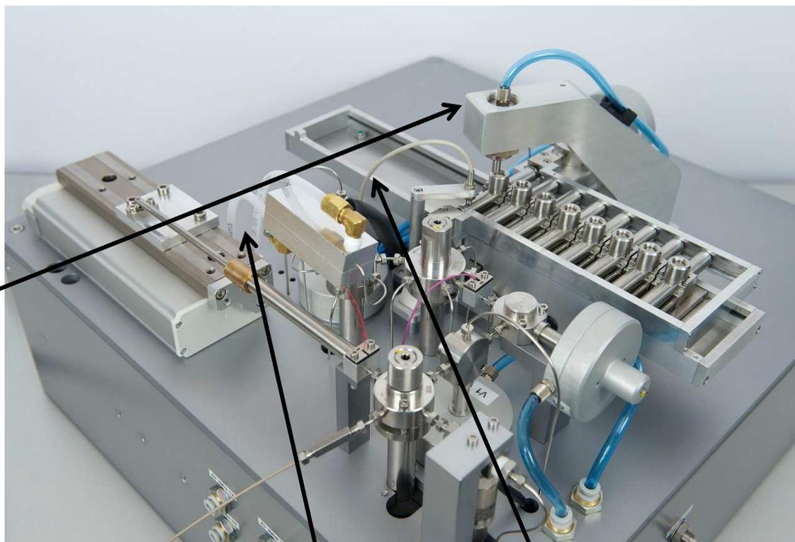
Seringue automatique avec moteur pas-à-pas, injectant un mélange  $CO_2$  (5%) + He (95%) dans la source d'ions
