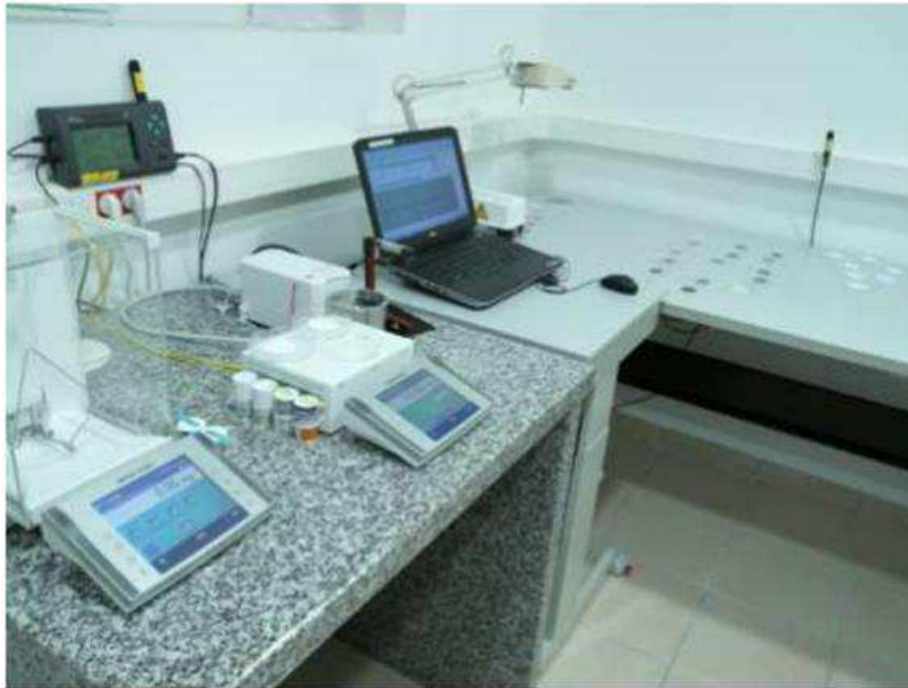
Photo 4 : Balances de précision utilisées dans le laboratoire de gravimétrie
