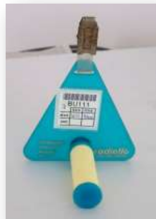
Boitiers et tube à diffusion passive pour la mesure du benzène
