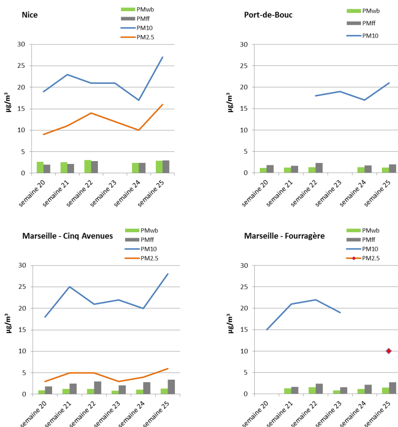
Concentrations hebdomadaires en particules issues de la combustion de bois et du trafic, et en particules PM10 et PM2.5 sur les quatre sites de mesure
