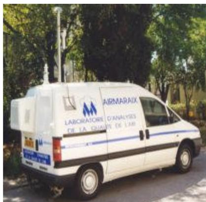
Ce type de camion a pour objectif premier de mesurer la qualité de l'air à des endroits qui ne possèdent pas de stations de mesure fixes et de vérifier si la qualité de l'air en ce lieu correspond à peu près, à celle de la station la plus proche.
