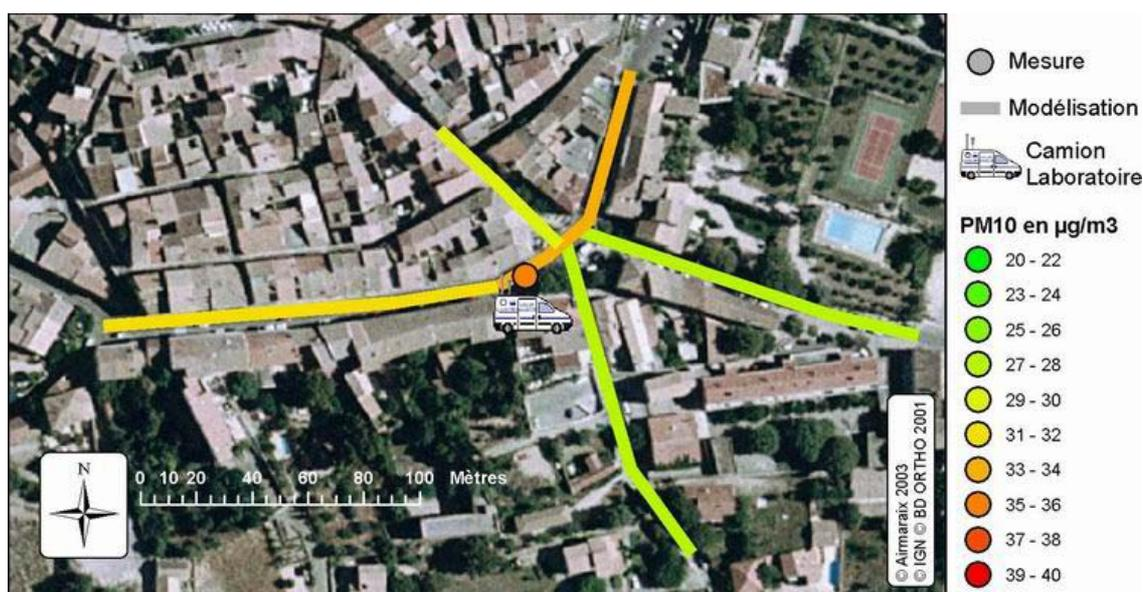
Figure n°9 : Carte de répartition des concentrations moyennes annuelle des  $PM_{10}$  ( $\mu\text{g}/\text{m}^3$ ) sur les axes du centre de Châteauneuf-du-Pape. La pastille représente les résultats issus des mesures in situ à l'aide du laboratoire mobile. Les lignes représentent les résultats issus de la modélisation avec le logiciel STREET4.0.
