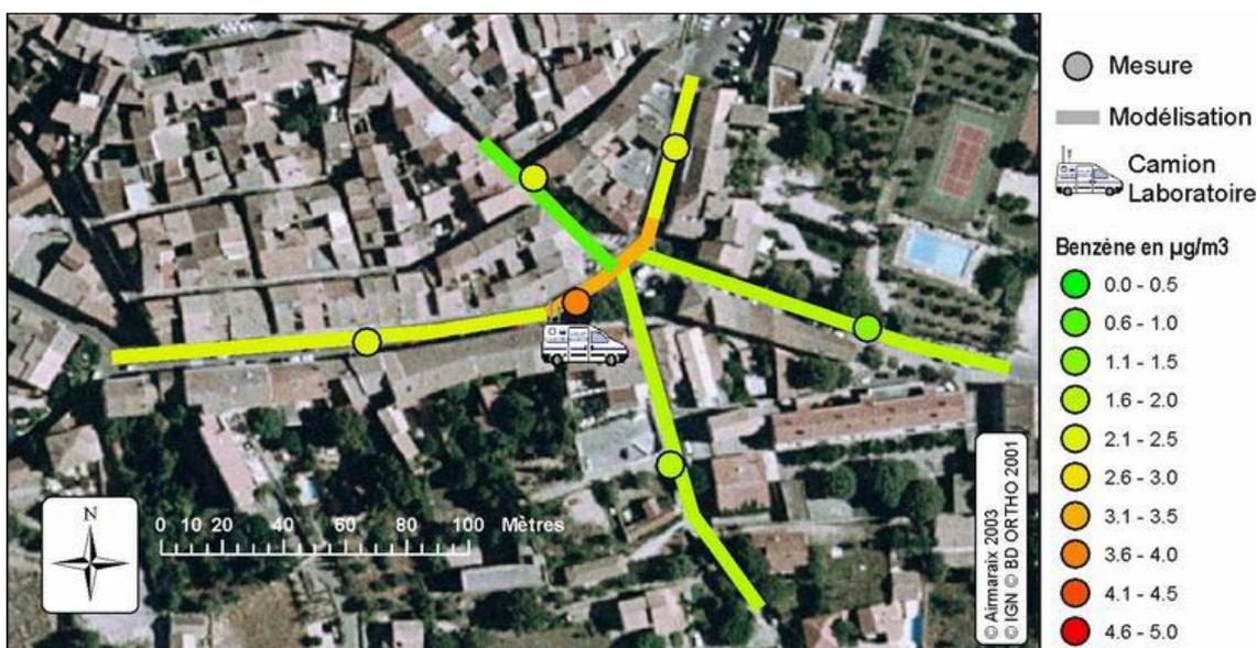
Figure n°8 : Carte de répartition des concentrations moyennes du Benzène ( $\mu\text{g}/\text{m}^3$ ) sur les axes du centre de Châteauneuf-du-Pape. Les pastilles représentent les résultats issus des mesures in situ à l'aide de tubes à diffusion passive (moyenne sur la période). Les lignes représentent les résultats issus de la modélisation avec le logiciel STREET4.0 (moyenne annuelle).
