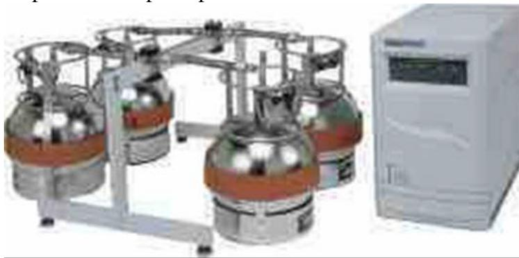
Les canisters sont des réservoirs métalliques de forme sphérique dont la paroi intérieure est recouverte d'une couche de silice désactivée. Cette couche permet de passiver la surface à l'égard de l'adsorption des composés à étudiés.
