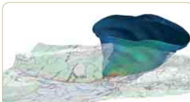
Simulation de la dispersion des odeurs avec un modèle mathématique "Gaussien" : La dispersion dépend des vents et de la stabilité de l'atmosphère.
