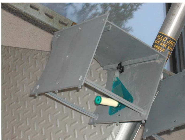
Figure 1 : Tube à diffusion passive pour la mesure des BTX, dans son abri
