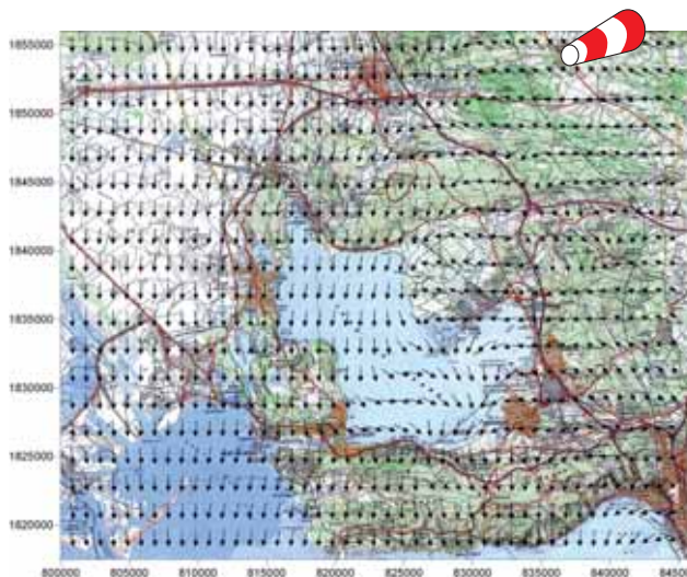
Champs de vents sur la zone AIRFOBEP utilisé par Odotrace : les effets du relief sont bien pris en compte.
