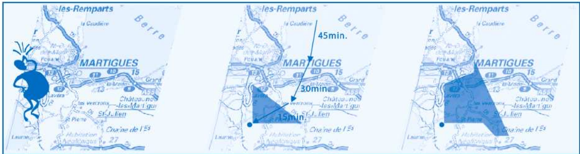
Figure 3 - Illustration de la méthode des cônes de gêne et de la rétrotrajectoire utilisés dans Odotrace pour délimiter la zone des sources probables d'odeurs (source AIRFOBEP)
