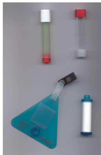
Figure 6 : Présentation des capteurs passifs
