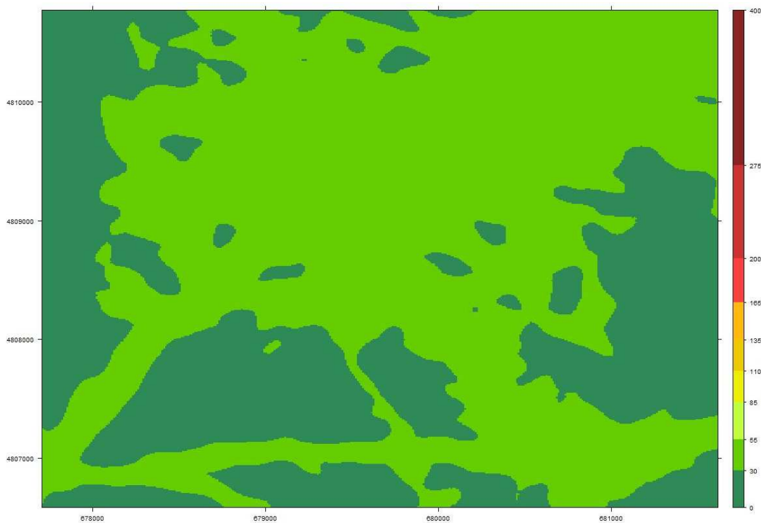
Figure 8 : Concentration maximale journalière en NO 2 (µg/m 3 ) sur l'agglomération de Marignane pour la journée du 01/04/2009, interpolée par krigeage avec dérive externe avec la variable auxiliaire Bâti+Axes routiers combinée aux émissions NOx
