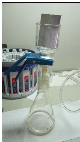
Figure 9 : Montage pour la dissolution du fixateur
