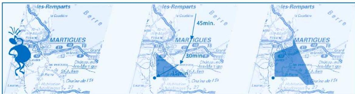
Figure 3 - Illustration de la méthode des cônes de gêne et de la rétrotrajectoire utilisés dans Odotrace pour délimiter la zone des sources probables d'odeurs (source AIRFOBEP)
