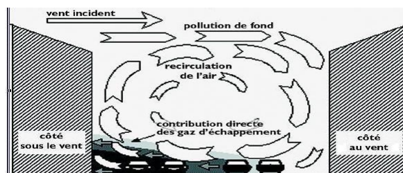
Figure 44 : schéma simplifié de l'écoulement dans une rue canyon
