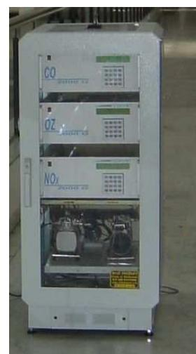
Figure 15 : Laboratoire mobile d'Atmo PACA – Cannes de prélèvement de l'air – Baie d'analyseurs
