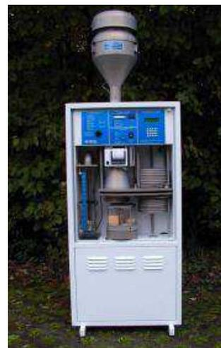
Appareil de mesure des HAP (DA80)
