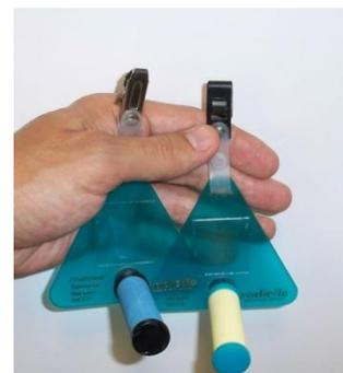
*Figure 2 : Exemple de tubes à diffusion passive*
