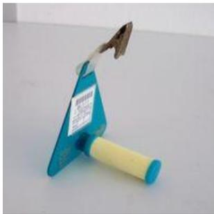
Figure 12 : photo d'un tube à diffusion passive
